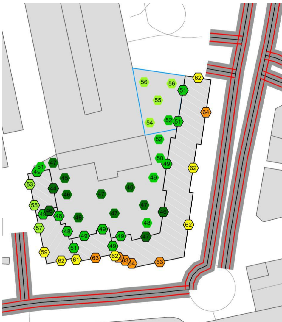
Figur 19 Vejstøjbelastning, vist som L_{den} i dB for den mest støjbelastede etage
